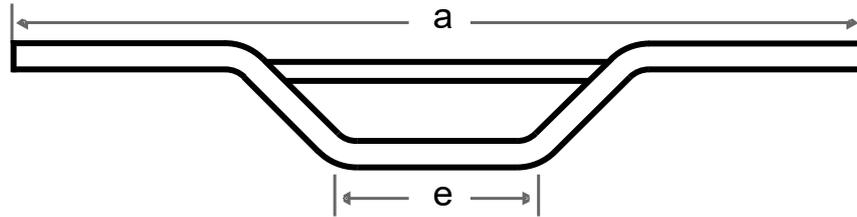
**Lenker mit Strebe aus Rohr 25,4 mm Ø (1“),
