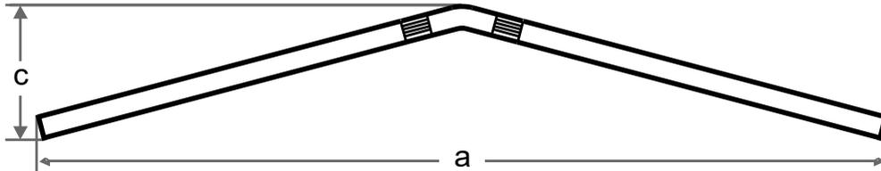
V-Bars können nur in Verbindung mit einzeln verdrehbaren Risern montiert werden, da sie nur 1 Biegung in der Mitte der Einspannstellen besitzen und je 1 Biegung außerhalb der Einspannstellen zum Ausgleich stärker geneigter Gabelbrücken. Bei der Ausführung (L V 3) darf eine max. Breite der Klemmstellen (Riser) von 135 mm nicht überschritten werden.
