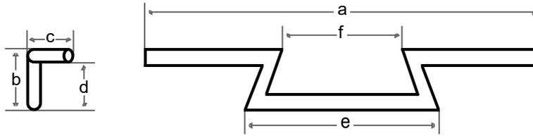
**Z-Lenker für Chopper und Cruiser aus Rohr 25,4 mm Ø (1") mit Kerbe für Elektrokabel (für alle HD ab Bj. 82). 5 Loch Kabelinnenführung (Je 1 Langloch in der Kabelkerbe im Bereich der Griffe, 2 x im Bereich der Einspannungen und 1 x zwischen der Einspannung).**
