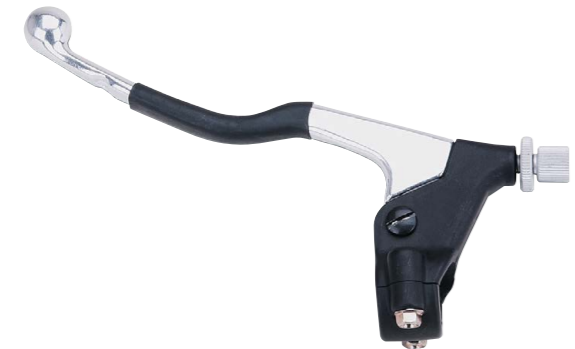
COD. 1707.04 Sinistro, leva con rivestimento in plastica Left, lever with plastic coating fulcro leva - lever fulcrum mm 24 lunghezza leva - lever length mm 167 codice leva - lever cod. 2266.60.35
