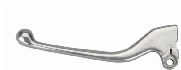
COD. 4460.61 Leva frizione lucida Polished clutch lever fulcro - fulcrum mm 24,5 lunghezza - length mm 140 codice portaleva - lever assembly cod. 3421.04
