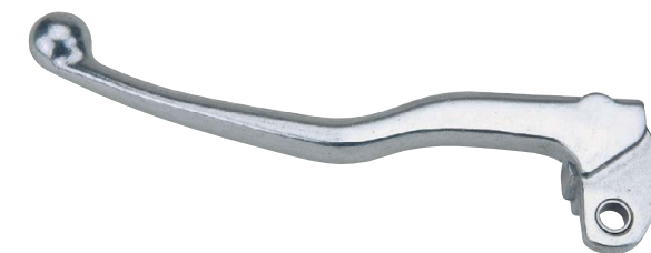
COD. 4225.61 Leva frizione lucida Polished clutch lever fulcro - fulcrum mm 32 lunghezza - length mm 189 codice portaleva - lever assembly cod. 3080.04 - 3103.04
