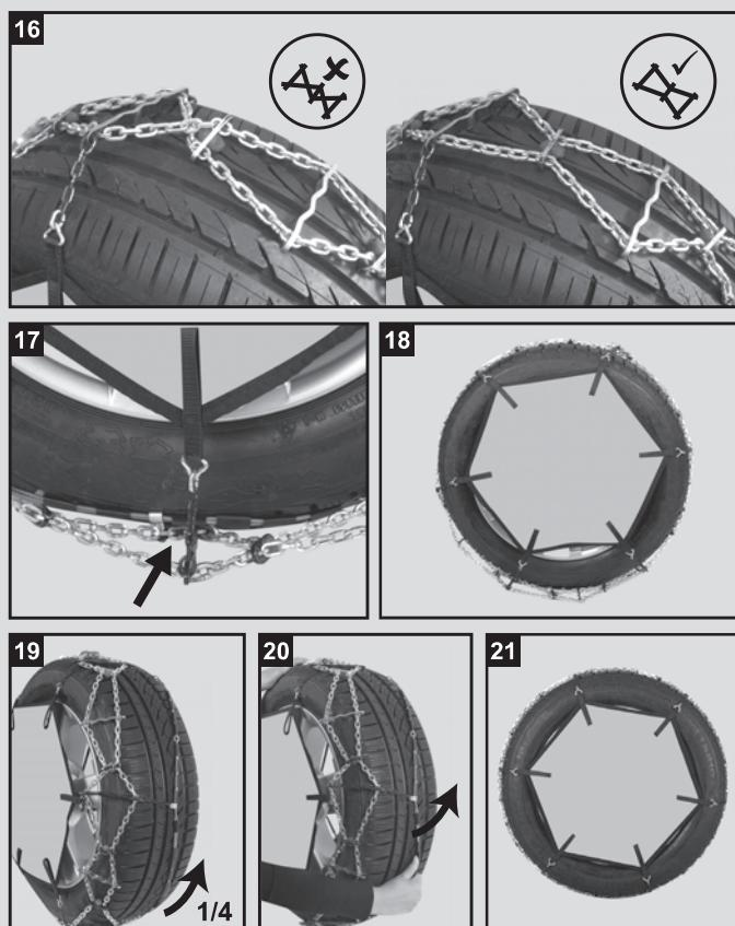
**FR : Attention!!** Vérifier que la bande de roulement de la chaîne n'est pas vrillée. (photos 16) Pousser l'élastique noir et orange aussi bas que possible vers le sol pour qu'il se trouve sur le bord de la bande de roulement du pneu comme le montre la flèche. (photo 17)
