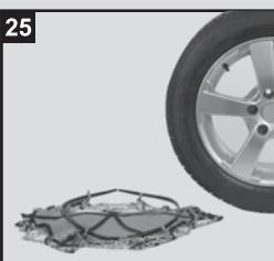
**FR:** Placez vos mains dans deux poignées diamétralement opposées. (photo 22). Desserrez la chaîne neige en la secouant légèrement(tirer alternativement sur la main gauche et la main droite)
