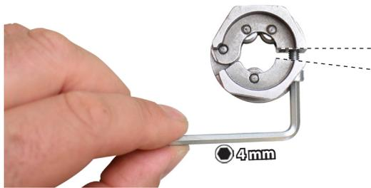
📷2: Rückformwerkzeug lagerichtig am Gewinde aufsetzen.
