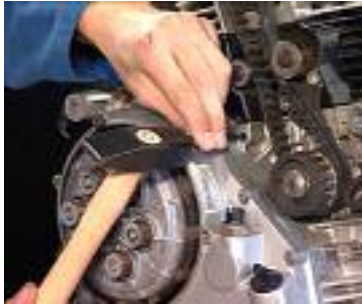
Bild 6: HELICOIL®plus Zapfen brechen
