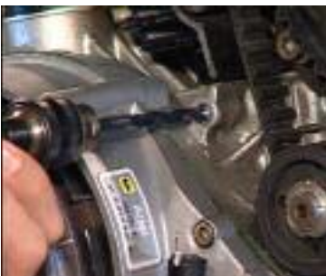
Bild 3: Kernloch bohren für HELICOIL ® plus-Aufnahmegewinde
