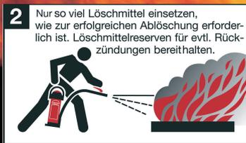
**2** Nur so viel Löschmittel einsetzen, wie zur erfolgreichen Ablöschung erforderlich ist. Löschmittelreserven für evtl. Rückzündungen bereithalten.
