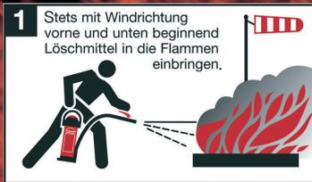
**1** Stets mit Windrichtung vorne und unten beginnend Löschmittel in die Flammen einbringen.
