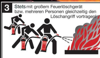
**3** Stets mit großem Feuerlöschgerät bzw. mehreren Personen gleichzeitig den Löschangriff vortragen!
