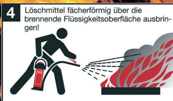
**4** Löschmittel fächerförmig über die brennende Flüssigkeitsoberfläche ausbringen!
