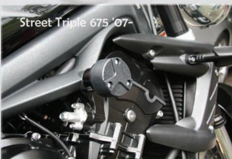
Beim Anbaumaterial und bei allen unseren Sturz pads, legen wir Wert auf höchste Effizienz. Deshalb fertigen wir unsere Pads von 45 bis 95mm Länge. Für jedes Motorrad passend ausgemessen, um ein ungünstiges Verlängern mit einer Buchse zu vermeiden.
